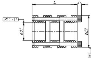
As buchas de fixação MMP DSM são concebidas para a fixação de cubos em pontas de eixo conforme a Norma DIN 748. Estas buchas também podem ser usadas em pontas de eixo que já possuam um rasgo para chaveta (ponta de eixo de motores, por exemplo), sem prejuízo para a fixação. Em motores com alto padrão de balanceamento (reduzida vibração, as pontas de eixo são normalmente fornecidas sem o rasgo para chaveta, a fim de preservar a simetria rotacional.
